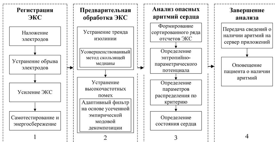
Рис. 1. Предлагаемый подход к мониторингу состояния сердца
